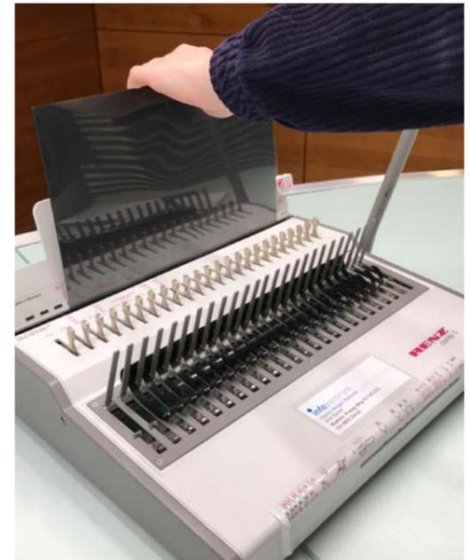
3. Legen Sie das hintere Deckblatt und das Klarsichtblatt in den hinteren Schlitz des Bindegeräts und ziehen Sie den grossen Hebel nach unten, um zu stanzen.
