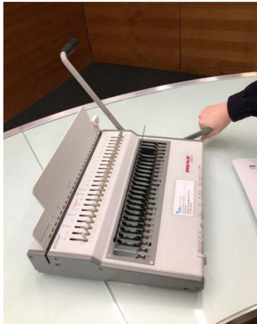
2. Ziehen Sie den kleinen Hebel, um den Plastikbinderücken zu öffnen.
