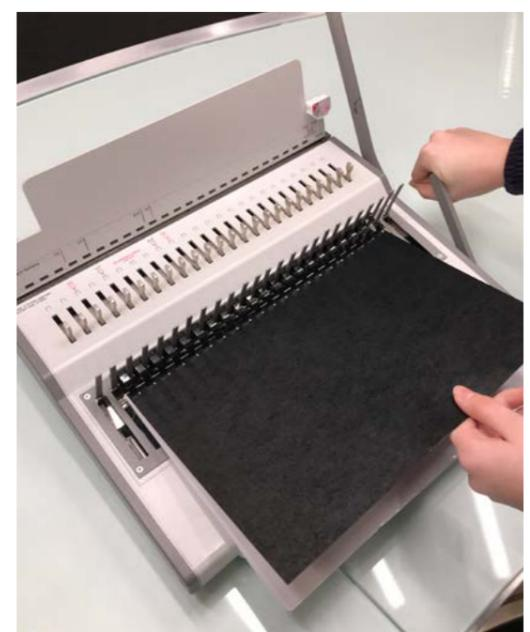
6. Legen Sie zum Schluss das hintere Deckblatt in den Binderücken ein und drücken Sie den kleinen Hebel wieder nach hinten, um den Binderücken zu schliessen.
