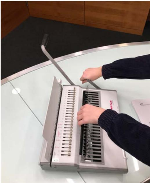
1. Schieben Sie den kleinen Hebel nach hinten und legen Sie den Plastikbinderücken in den Metallkamm.
